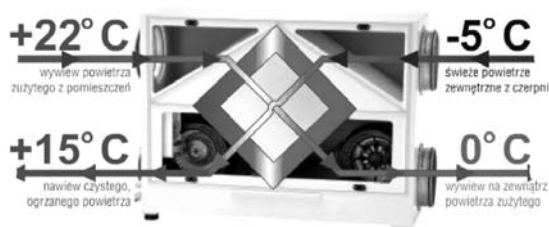
Rysunek 19. Schemat działania wymiennika krzyżowego
